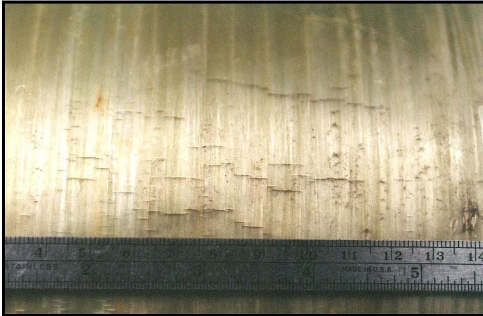
شکل ۱- مثالی از آسیب ترک خوردن ناشی از تنش و خوردگی در مخزن کامپوزیت با الیاف شیشه‌ای
