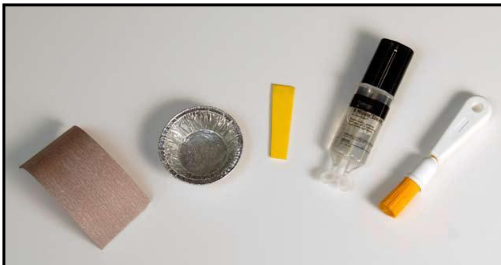
شکل ث-۱- وسایل لازم برای ترمیم مخازن کامپوزیت
